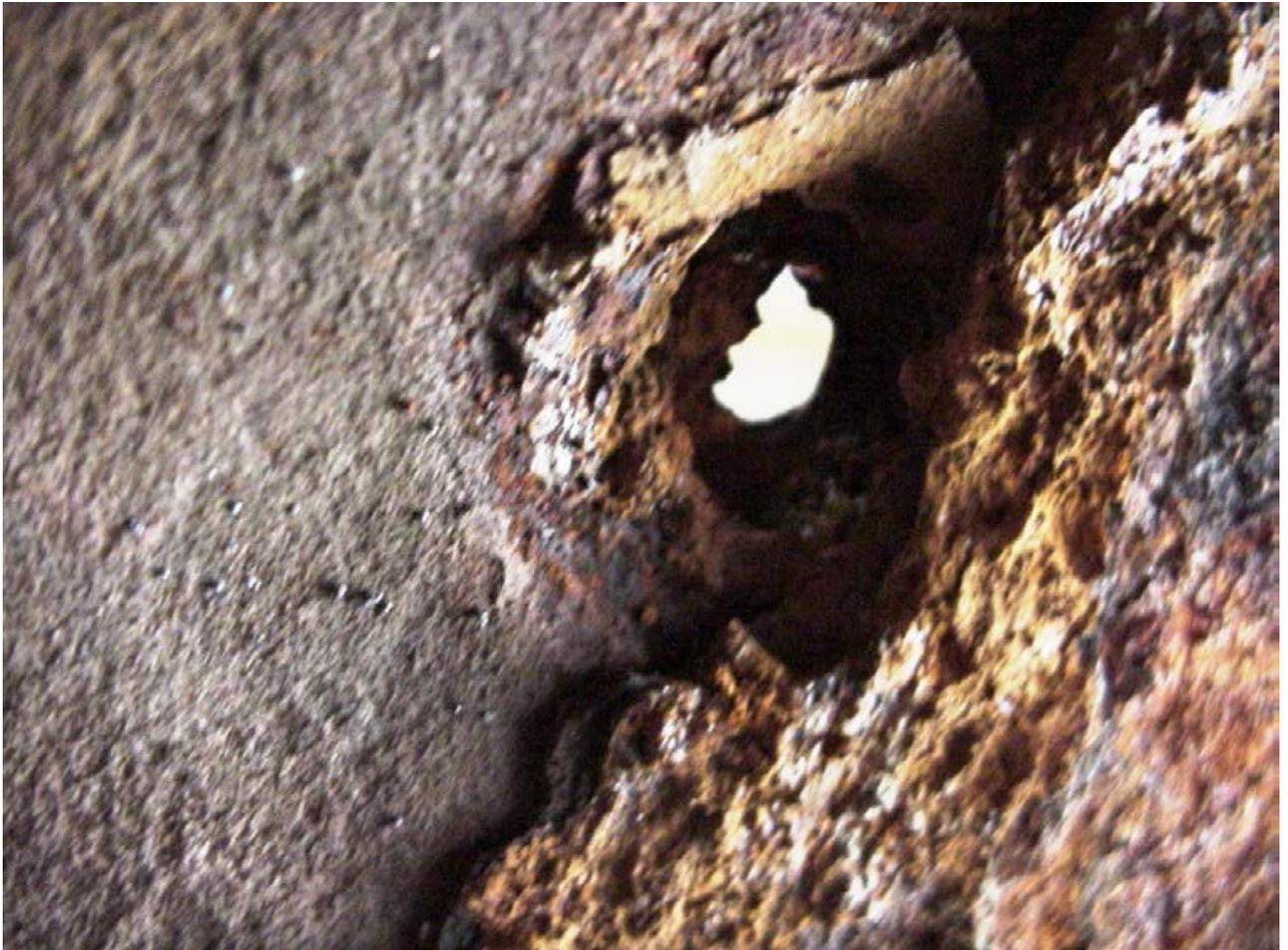
Figura AII.1: Detalle picadura «*pin-hole*» por MIC
