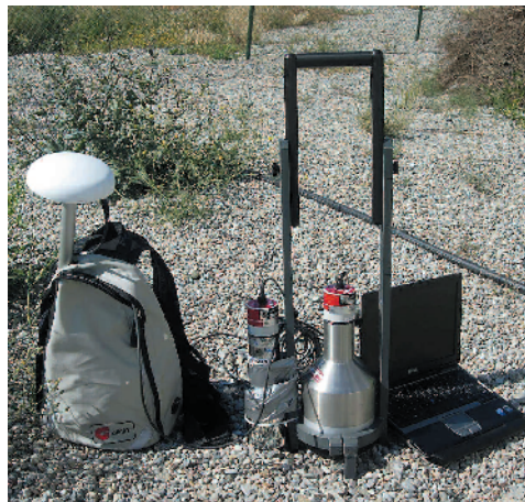
Detalle del detector de actividad del americio.
