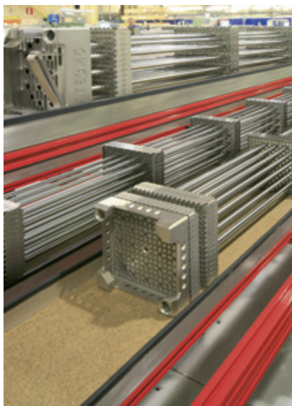
Barras de combustible.
