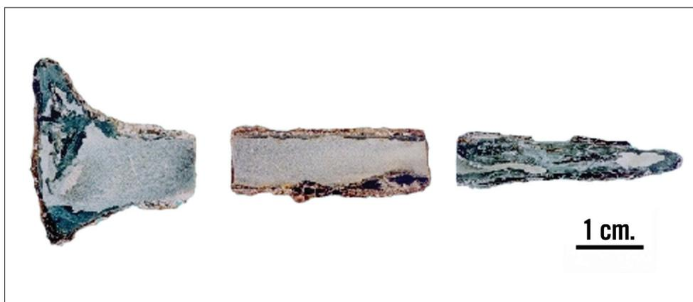
Figura Tr-4.- Corte longitudinal de uno de los clavos perteneciente al yacimiento de la Boca 2 del túnel, Trespaderne (Burgos). Ataque: Nital 4%, 15 s.
