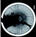
Vainas PWR (M5-H1, M5-H2, Z2, Z3, Z4): únicamente ensayos de barras de muy alto quemado observándose un fuerte aumento de la deformación al aumentar el tiempo de permanencia a potencia: rotura de una barra, conclusiones de interés para RIA (seguimiento de cambios de diámetro, hinchamiento pastilla)
