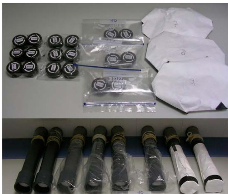
Figura 1. Detectores pasivos de Makrofol (arriba) y de LR115 (abajo) sin filtro (los de la izquierda) y con filtros (el resto).
