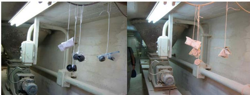
*Figura 28. Detectores de Makrofol con distintos tipos de membranas de polietileno en el punto P11: instalación (foto izquierda) y recogida recubierta de polvo (foto derecha).*
