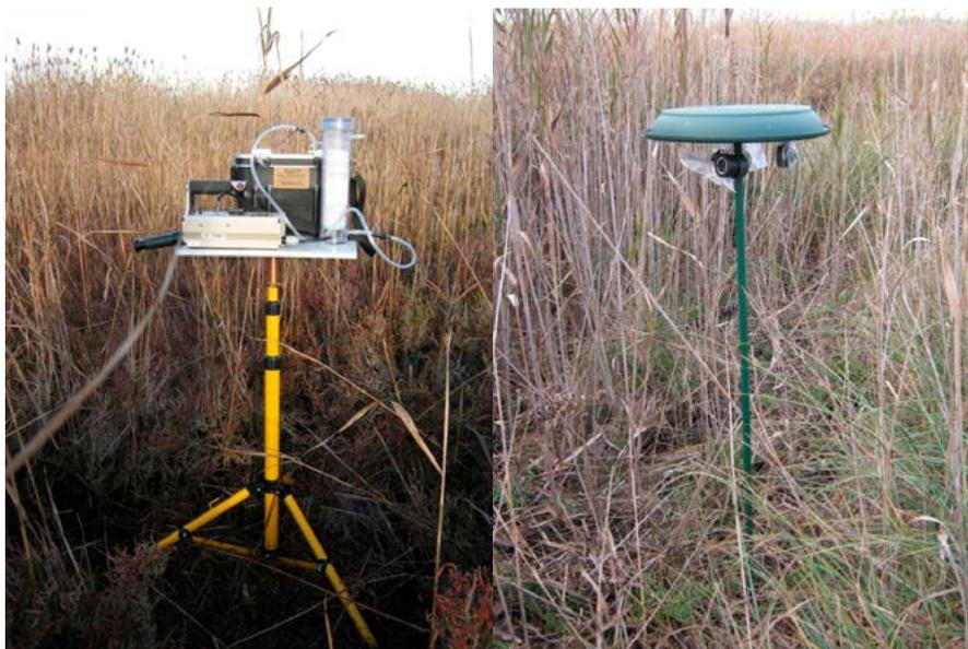
*Figura 44. Sistema de medida de la concentración de radón en el aire exterior del marjal de Peñíscola. Imagen izquierda: monitor RAD 7, junto con el detector gamma Eberline. Imagen derecha: detectores de Makrofol bajo la cubierta protectora.*
