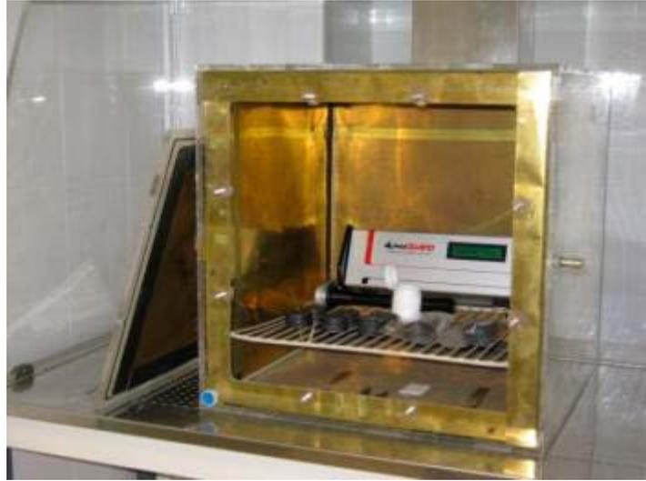
Figura 2. Cámara de radón de la UAB. En su interior se observa el monitor AlphaGUARD, un bote blanco con pechblenda y algunos detectores de Makrofol.
