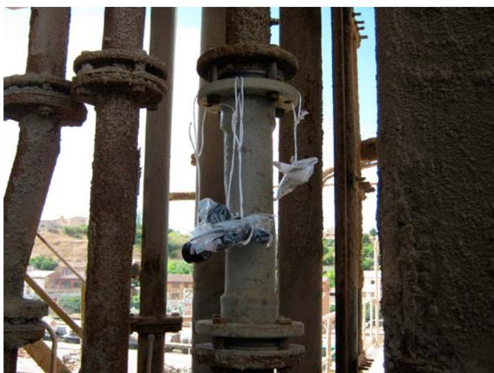
*Figura 29. Detectores de Makrofol con distintos tipos de membranas de polietileno en el punto P15: foto superior instalación e inferior izquierda recogida de los detectores. Estos detectores estaban situados en el exterior, cerca de los reactores que producen vapores de los ácidos que digieren la roca, foto inferior derecha.*
