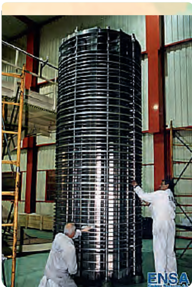
Ilustración 1. Internos del contenedor ENSA-DPT: discos de refrigeración y bastidor
