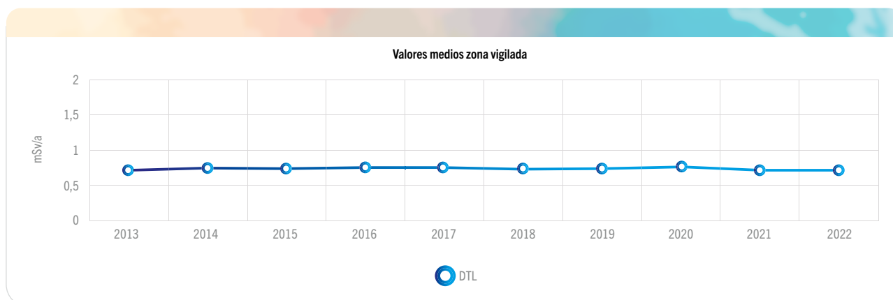
Gráfica 4.1.4.1.9. Radiación directa. Dosis integrada. Valores de los DTL. Central nuclear Santa María de Garoña
