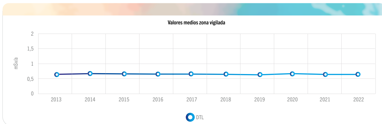
Gráfica 4.1.4.4.9. Radiación directa. Dosis integrada. Valores de los DTL. Central nuclear Cofrentes
