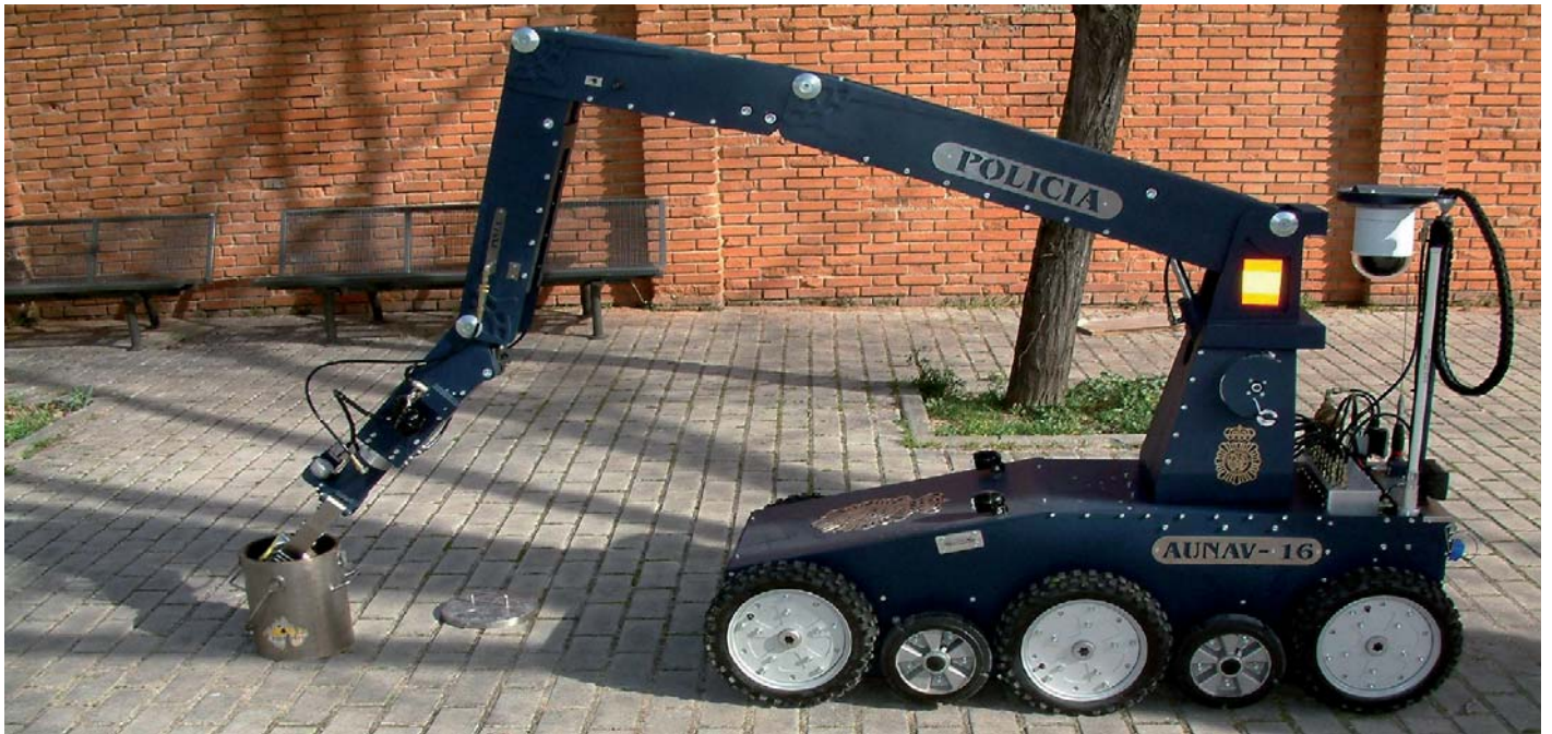
Robot en el transporte de una fuente radiactiva.
