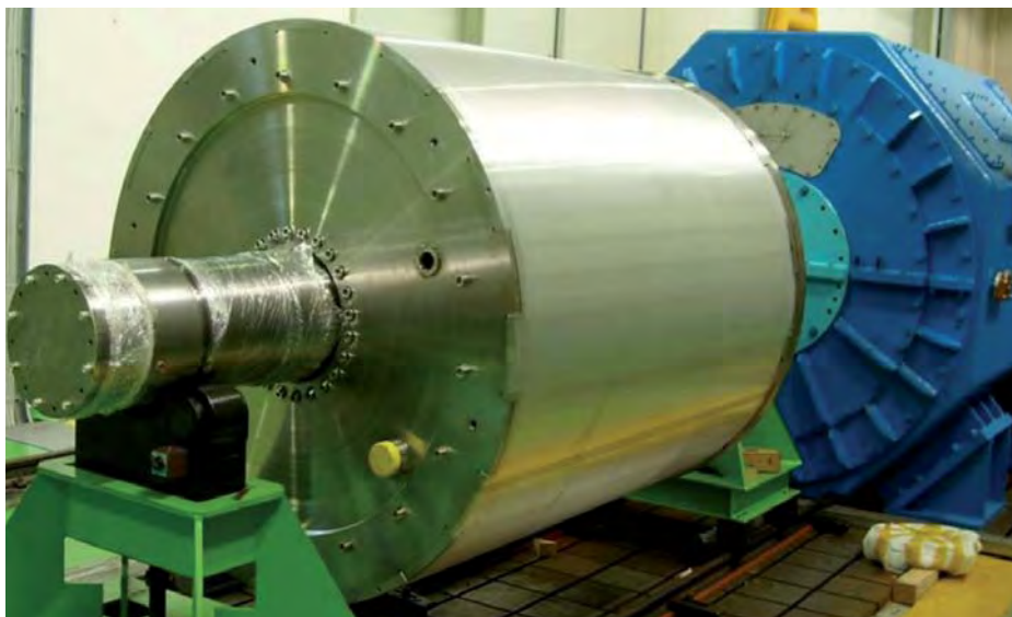
Fabricación del motor superconductor HTS de 5 MW realizado en Corea.
