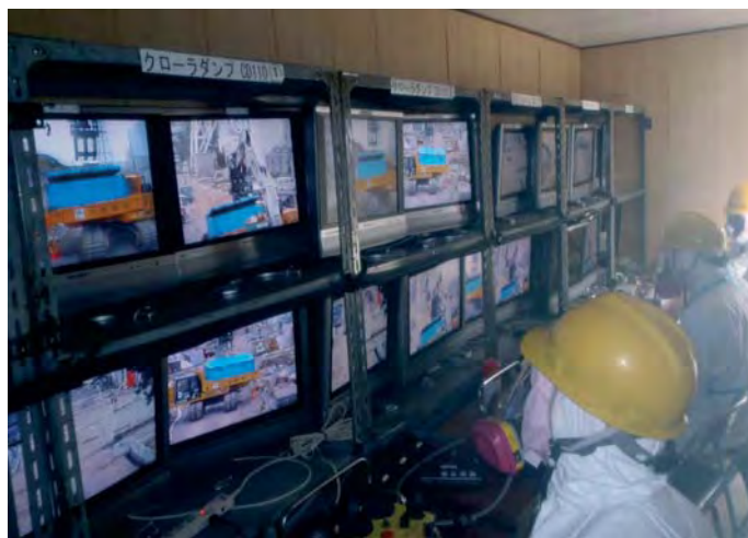
Centro de control remoto de maquinaria.
