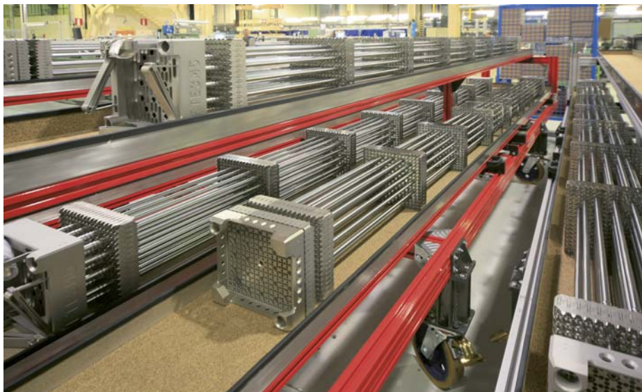
Los elementos combustibles, durante el proceso de fabricación en las instalaciones de Enusa.
