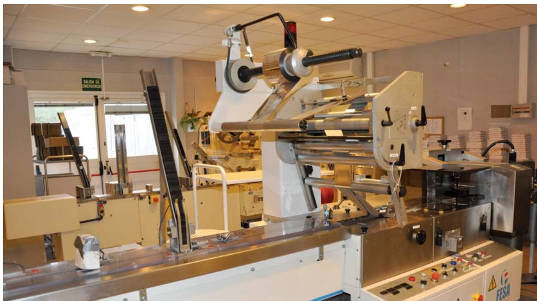
Vista general de la empaquetadora de dosímetros.
