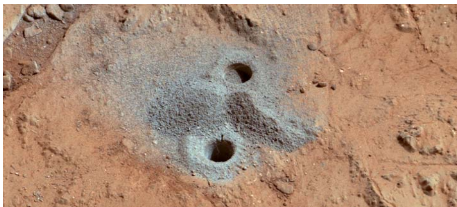
En esta imagen se aprecian los primeros agujeros taladrados en roca por el vehículo Curiosity y los restos generados durante el proceso. Parte del polvo de roca extraído del fondo del agujero fue analizado por los instrumentos del interior del vehículo.
