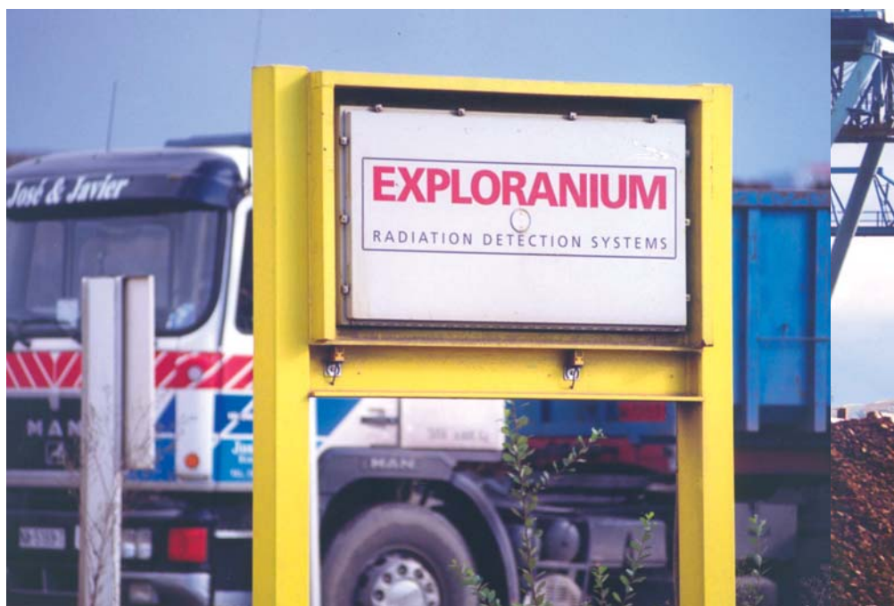
Pórtico colocado a la entrada de una acería para detectar la posible presencia de fuentes radiactivas.
