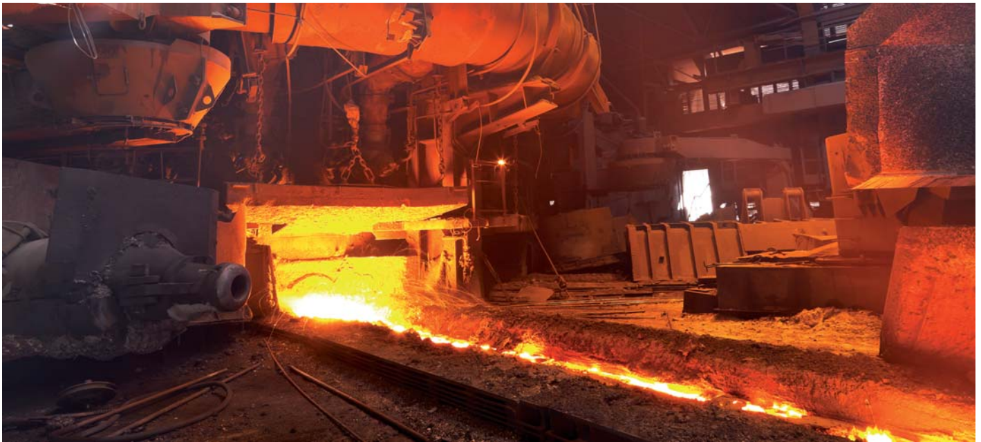
Horno de una acería donde se funden y reciclan materiales metálicos. Una fuente radiactiva puede contaminar todo el material final.
