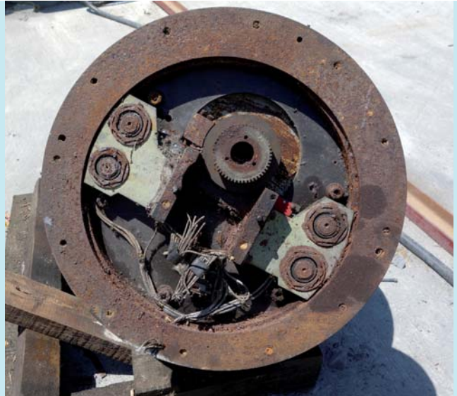
Cabezal de teleterapia que contiene una fuente radiactiva.
