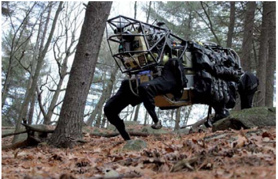
Big Dog corre por terrenos escarpados a 6,5 km/h.
