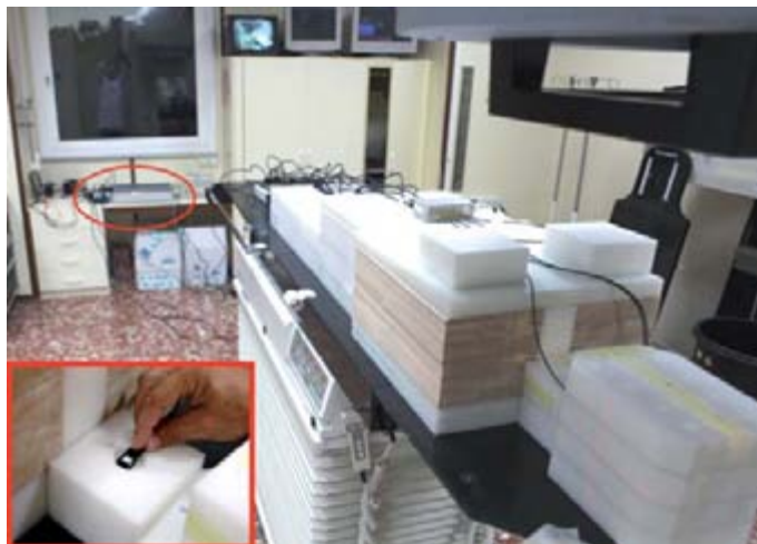
Figura 9. Maniquí antropomórfico con el detalle de la ubicación de ambos detectores SRAM (marcado en rojo, junto al muro frente al acelerador) y TNRD (en el interior del maniquí).
