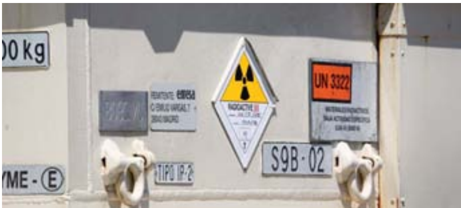
Arriba, descarga y estibado de materiales radiactivos que van a ser transportados. Abajo, señalización de un vehículo autorizado para el transporte de materiales radiactivos.
