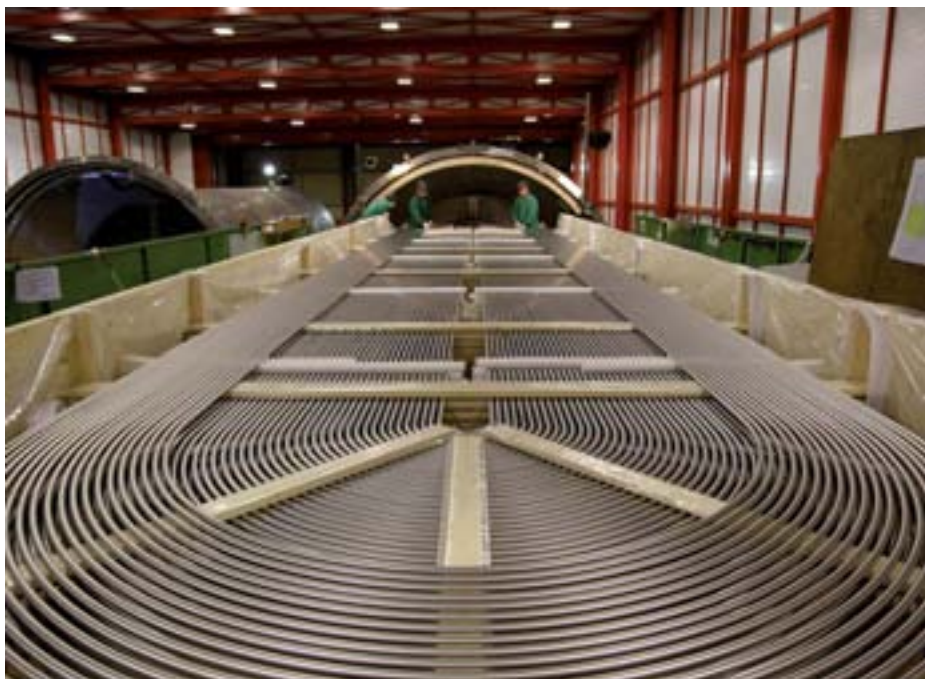
Montaje de haz tubular.
