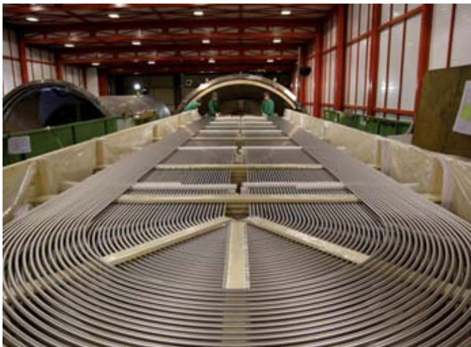
Montaje de haz tubular.
