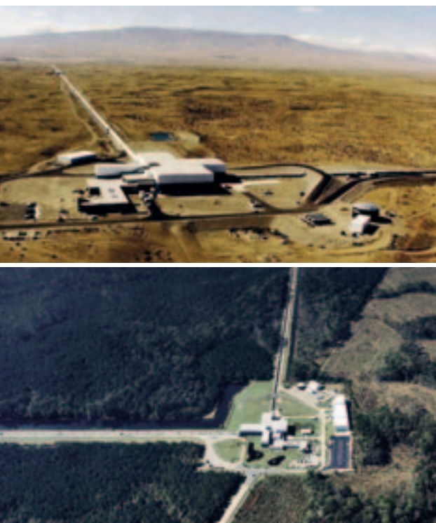
El LIGO de Louisiana (EE UU) dispone de un sistema interferométrico láser de dos brazos perpendiculares y en condiciones de vacío con un recorrido óptico de cuatro kilómetros.
