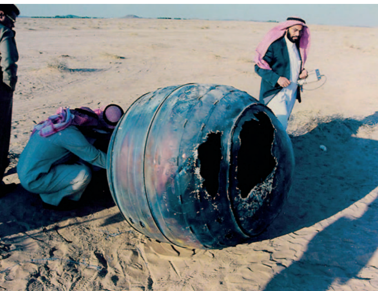
A la izquierda, carcasa de titanio del motor de un módulo Delta; con un peso de 70 kilos, aterrizó sobre Arabia Saudí a unos 240 km de Riad. A la derecha, un depósito de carburante de un cohete de lanzamiento Delta 2 que, con un peso de 250 kilos, aterrizó cerca de Georgetown.
