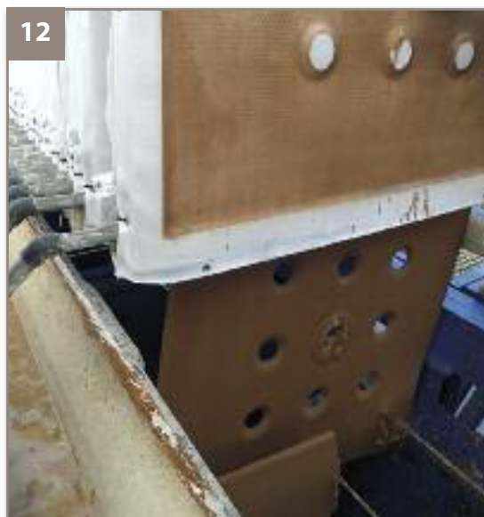
11-12. LA ETAPA DE FILTRACIÓN SE REALIZA MEDIANTE UN FILTRO-PRENSA. En el cual se consigue concentrar todo el material fino compactado en condiciones adecuadas ("tortas").
