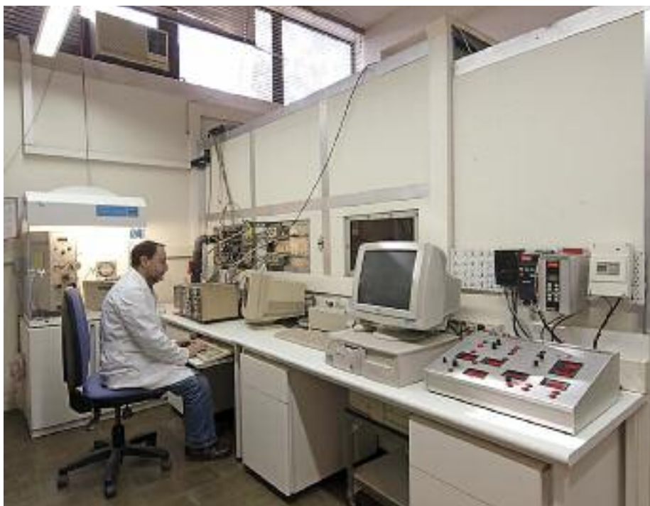
Figura 3. Cámara de radón INTE-UPC.
