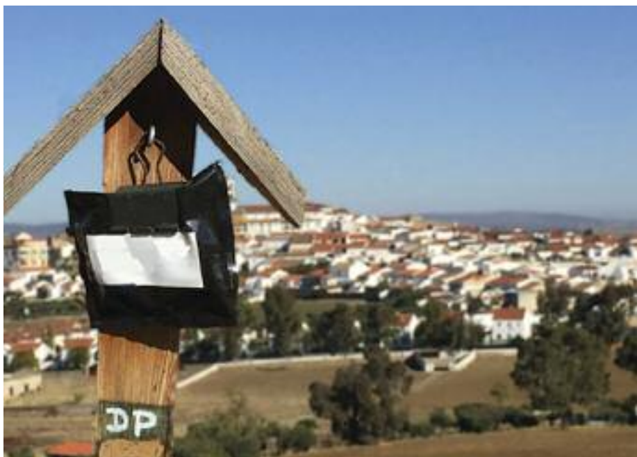
Dosímetro de medida de radiación gamma ambiental.
