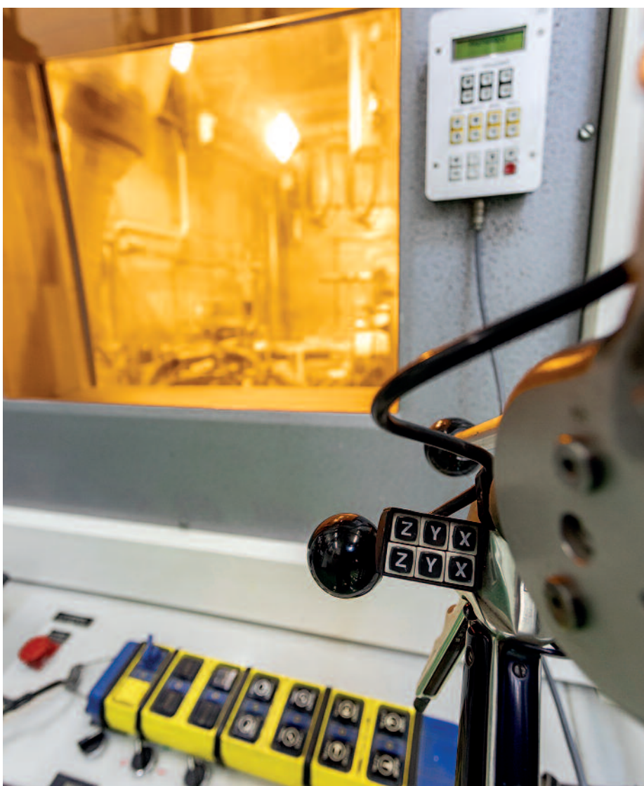
Telemanipuladores celda caliente del laboratorio activo.
