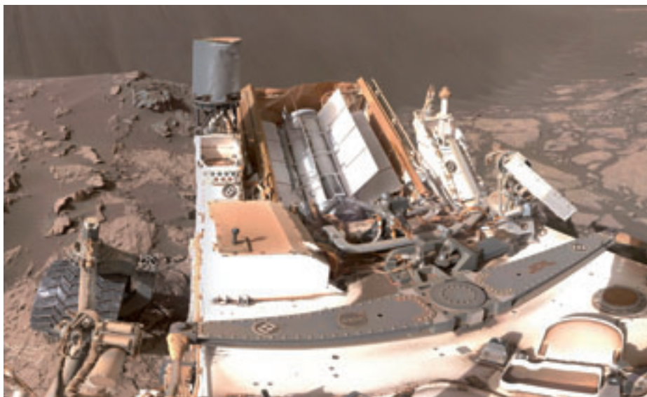
El generador termoeléctrico del vehículo de exploración de Marte Curiosity se aprecia en esta fotografía tomada por las cámaras de a bordo en la superficie del planeta rojo.
