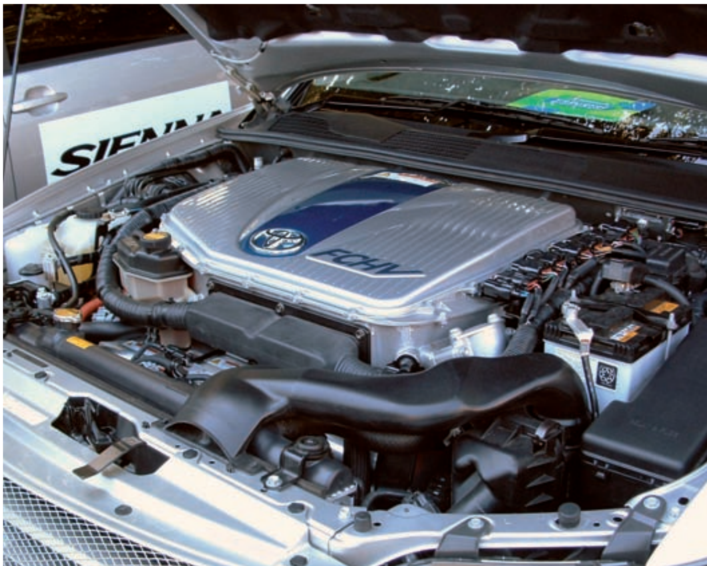
Motor de célula de combustible instalado en un vehículo de la marca Toyota.
