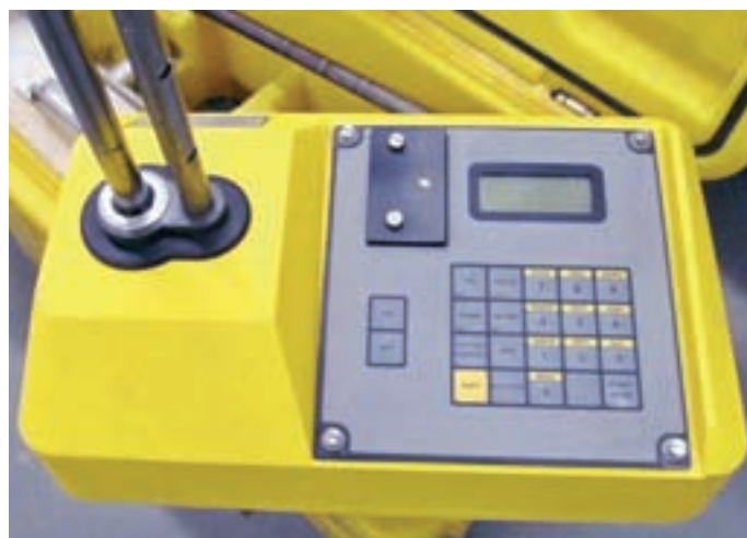
Equipo troxler para la medición de la humedad y la densidad del suelo, semejante al sustraído en marzo pasado.
