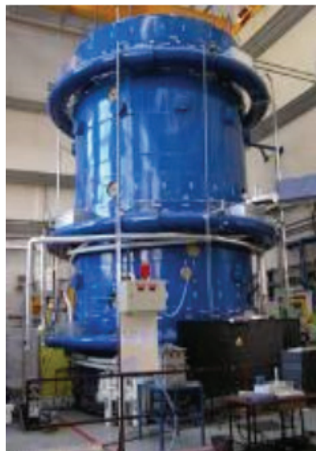
Figura 4 Instalación experimental MISTRA (Fuente: CEA)
