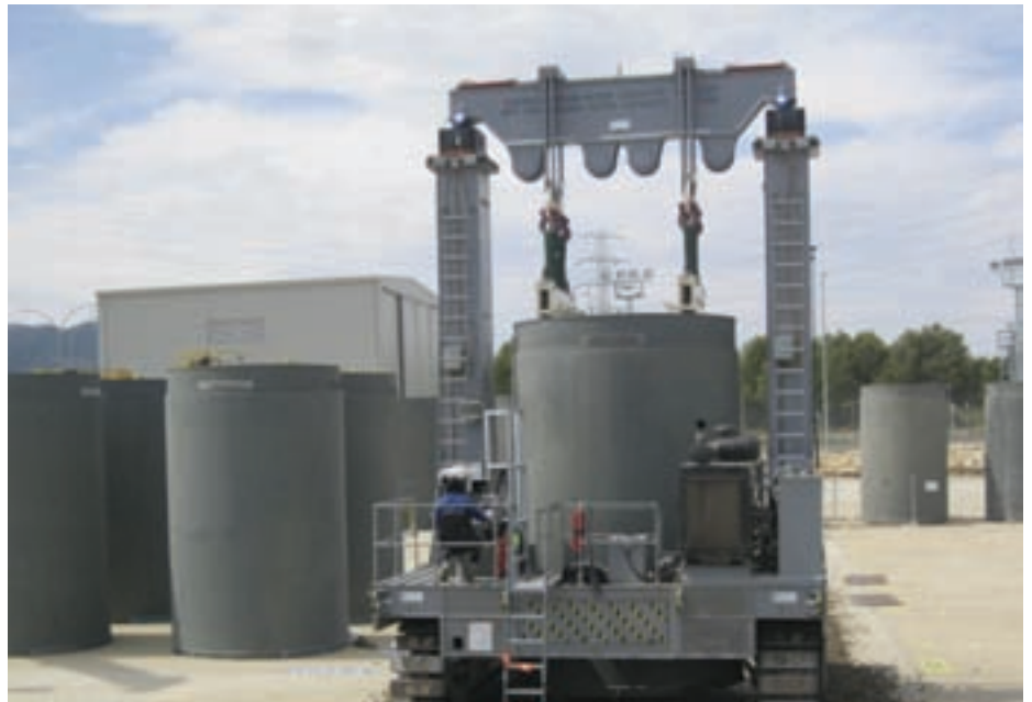
Contenedores en los ATI de Trillo y José Cabrera.
