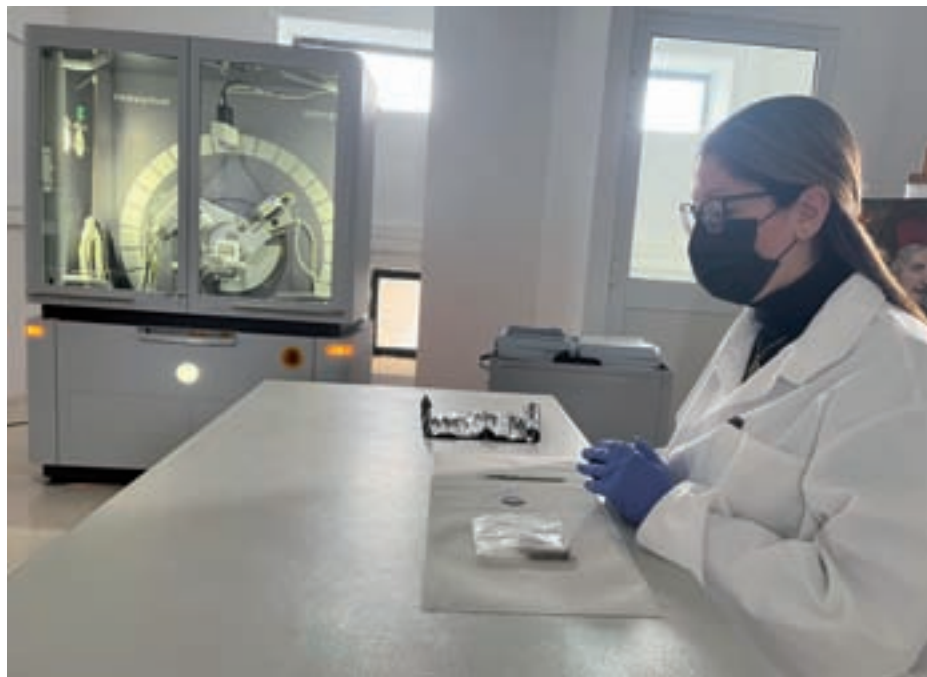
Investigadora del OIEA trabajando con el difractor de rayos X (XRD).
