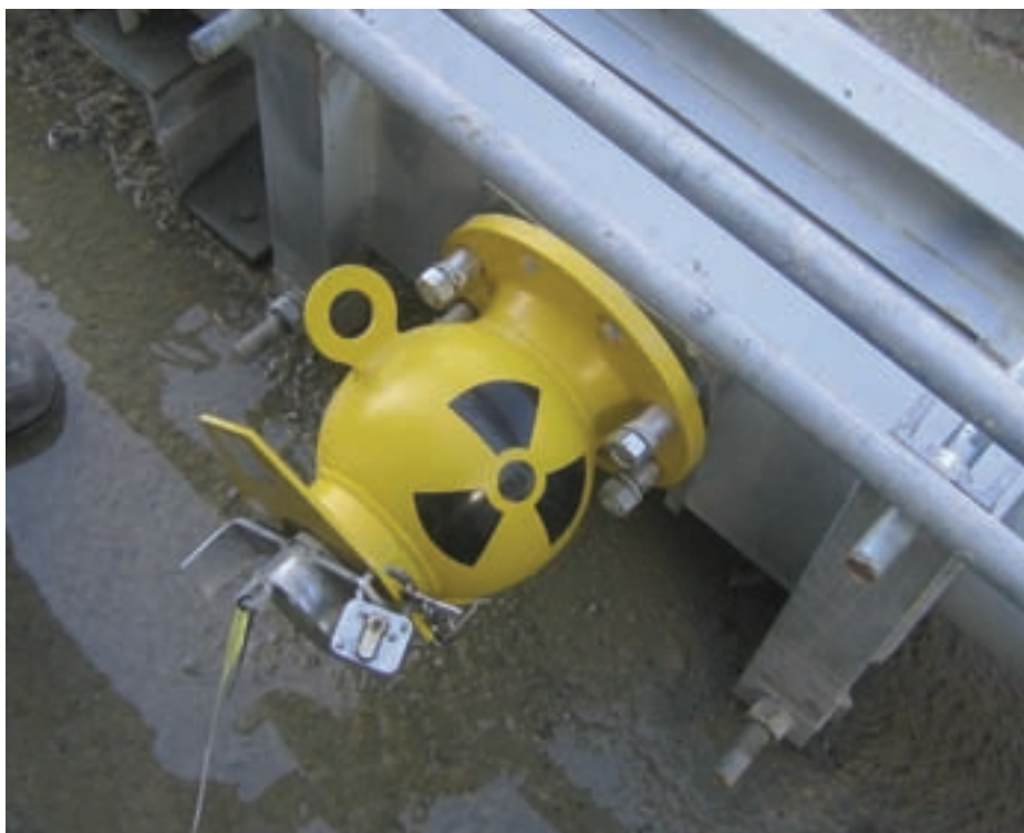
Fuente radiactiva encapsulada para control de procesos.
