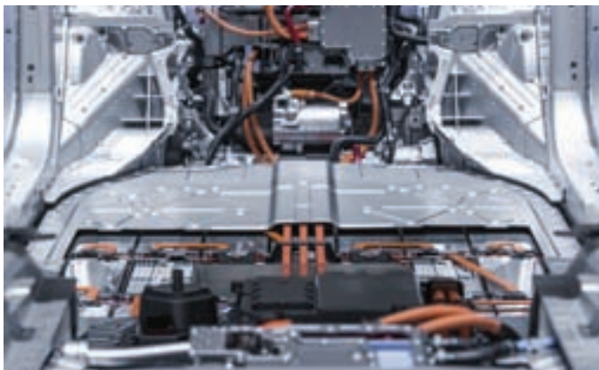
Batería de litio de un coche eléctrico y conexiones de alimentación. Derecha, batería de níquel de Tesla y la Universidad Dalhousie, montada en un prototipo.
