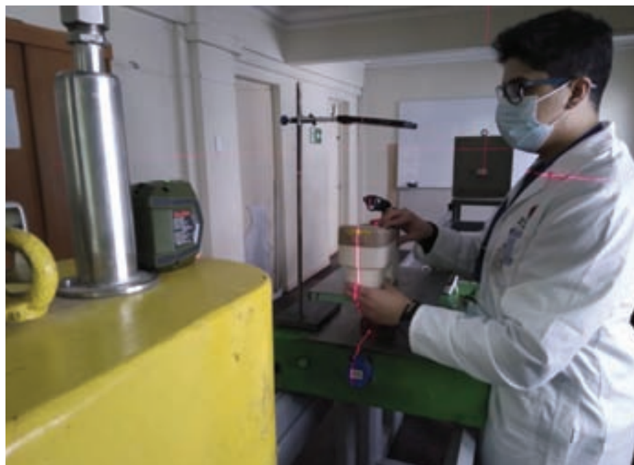
Calibración de detectores de radiación ionizante.
