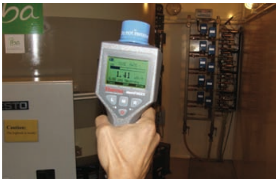
Medición de radiación en una instalación radiactiva.
