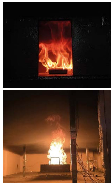
Figura 2. Ensayos experimentales de combustión en atmósfera viciada
