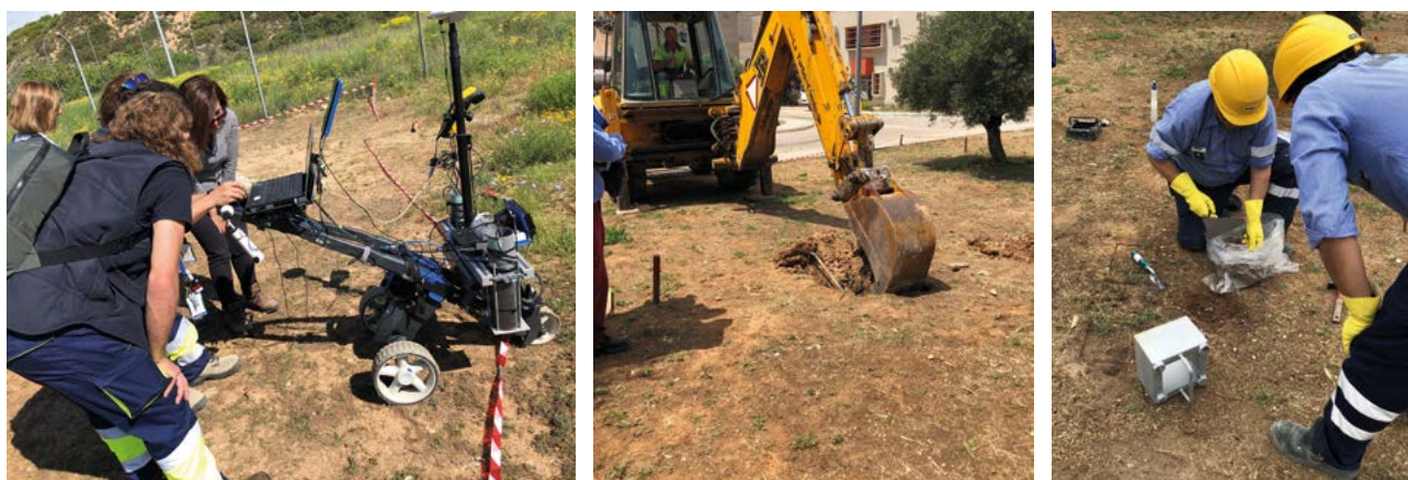
Figura 2. Medida y muestreo de suelos durante el desmantelamiento
