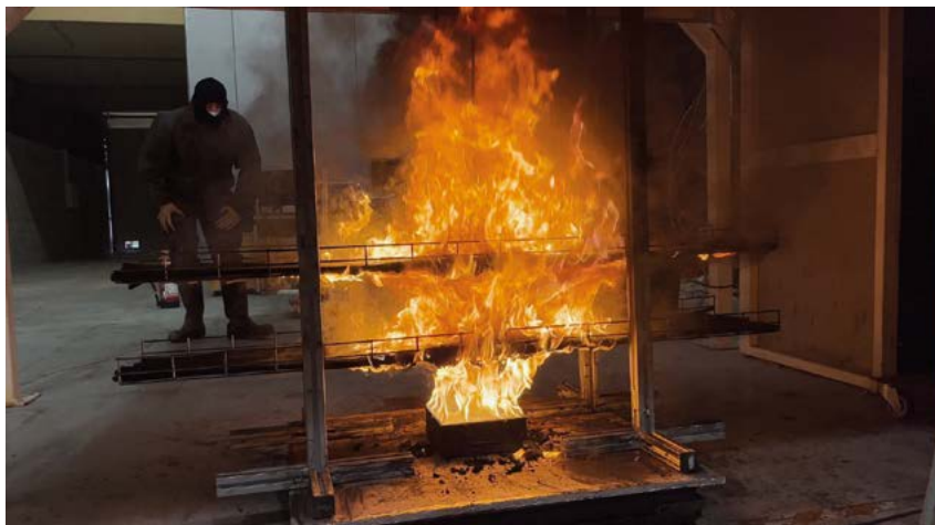
Figura 1. Ensayos experimentales de propagación del fuego en bandejas de cables
