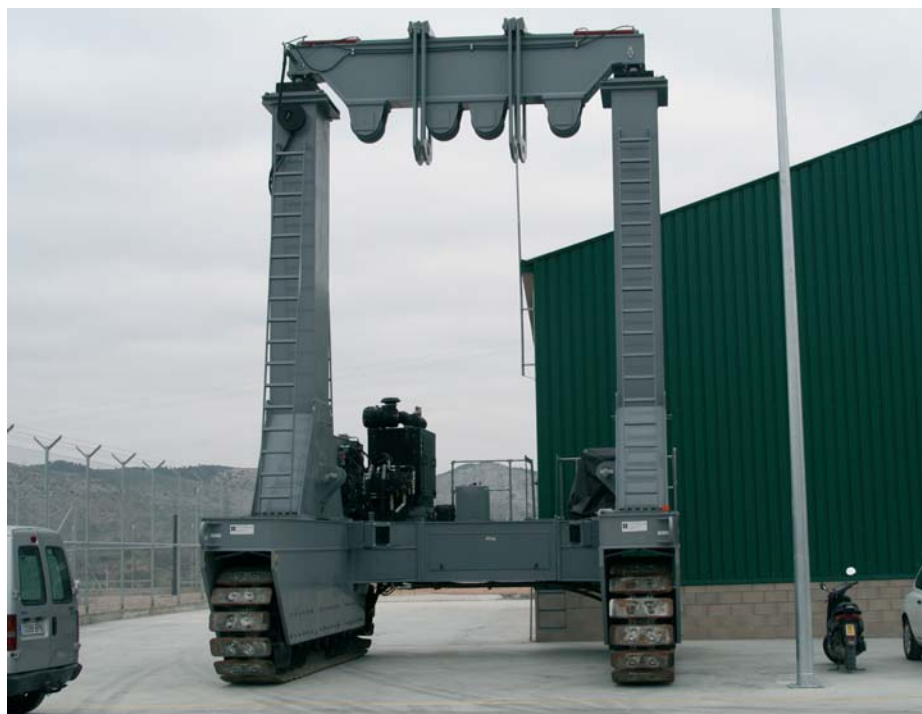
Figura 3. Dispositivo de traslado del contenedor HI-SORM.
