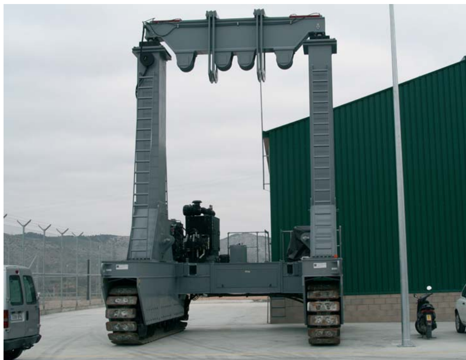
Figura 3. Dispositivo de traslado del contenedor HI-SORM.
