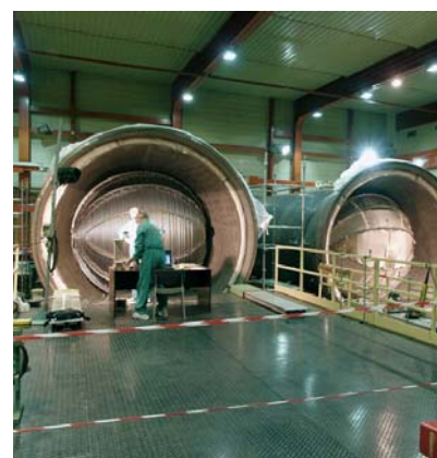
Construcción de los generadores de vapor en la fábrica de ENSA en Cantabria.
