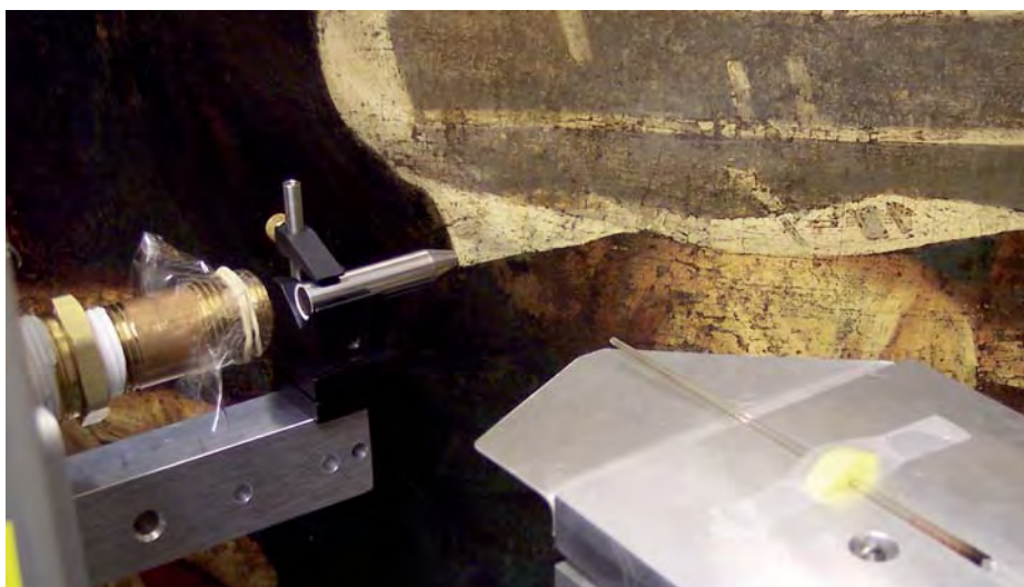
Uso de rayos X confocales para examinar capas de pintura subyacentes.
