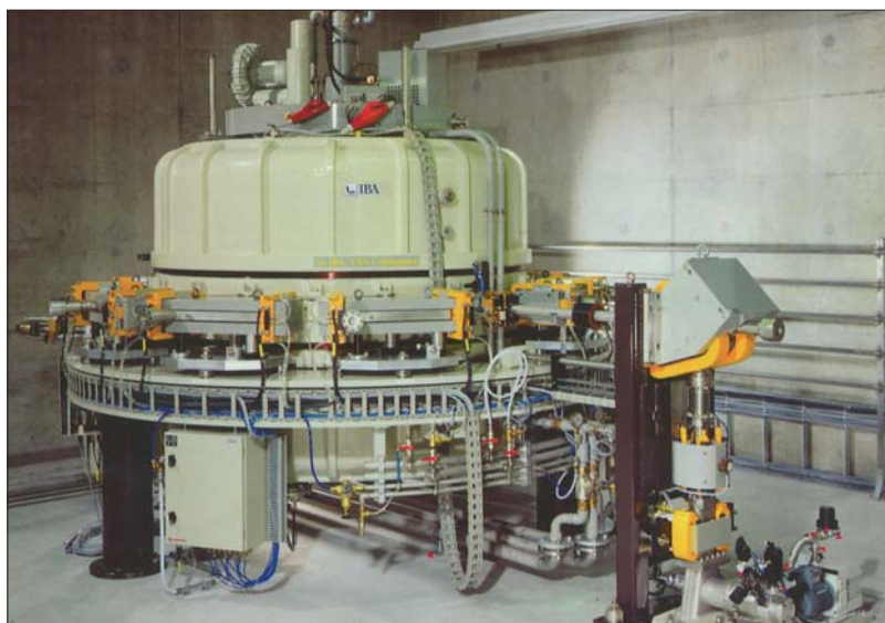
Acelerador de electrones Rhodotron.
