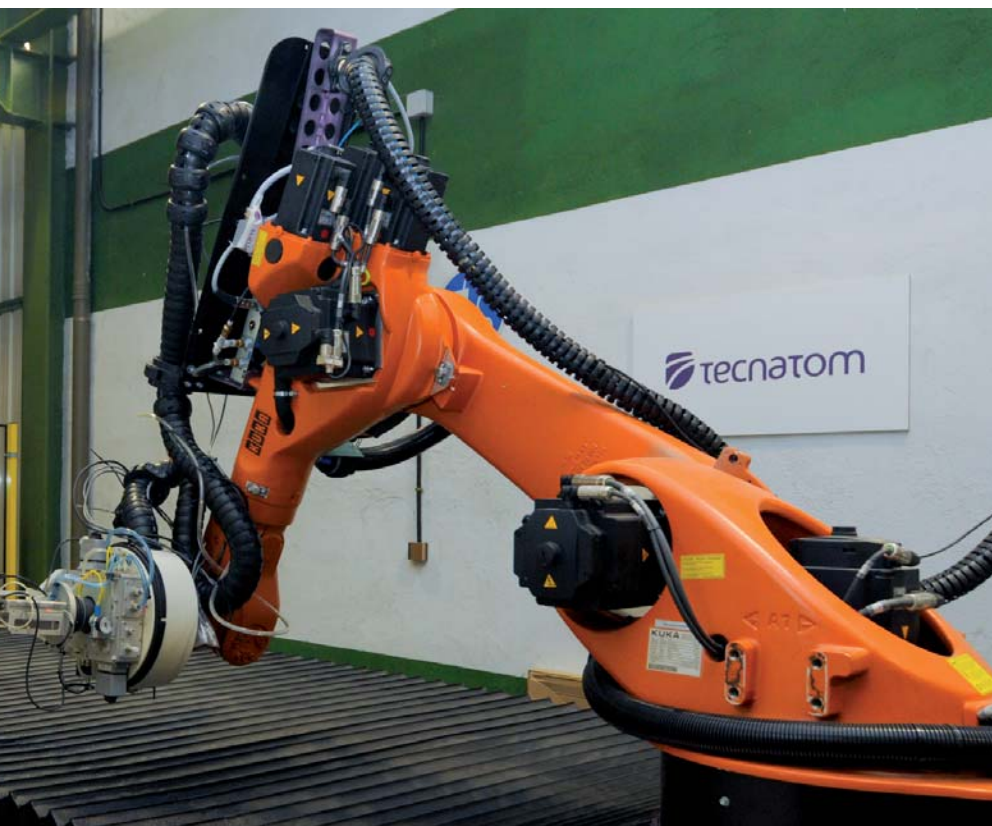
Robot utilizado para la inspección de componentes aeronáuticos, estudiando la tapa del reactor de un Airbus 380.
