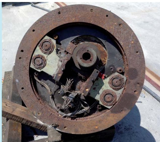
Cabezal de teleterapia que contiene una fuente radiactiva.
