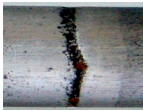
Figura 4. Estado de la varilla y de la zona de soldadura contenida en un equipo de medida de densidad y humedad en suelos.
