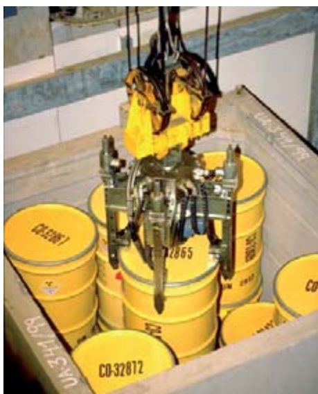
Vista aérea del almacén de residuos de baja y media actividad de El Cabril. Manejo automatizado de los bidones con los residuos y los contenedores donde se alojan.
