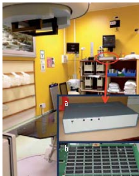
Figura 3. Localización del detector de neutrones térmicos en la sala de tratamiento. Vista (a) externa e (b) interna del detector.
