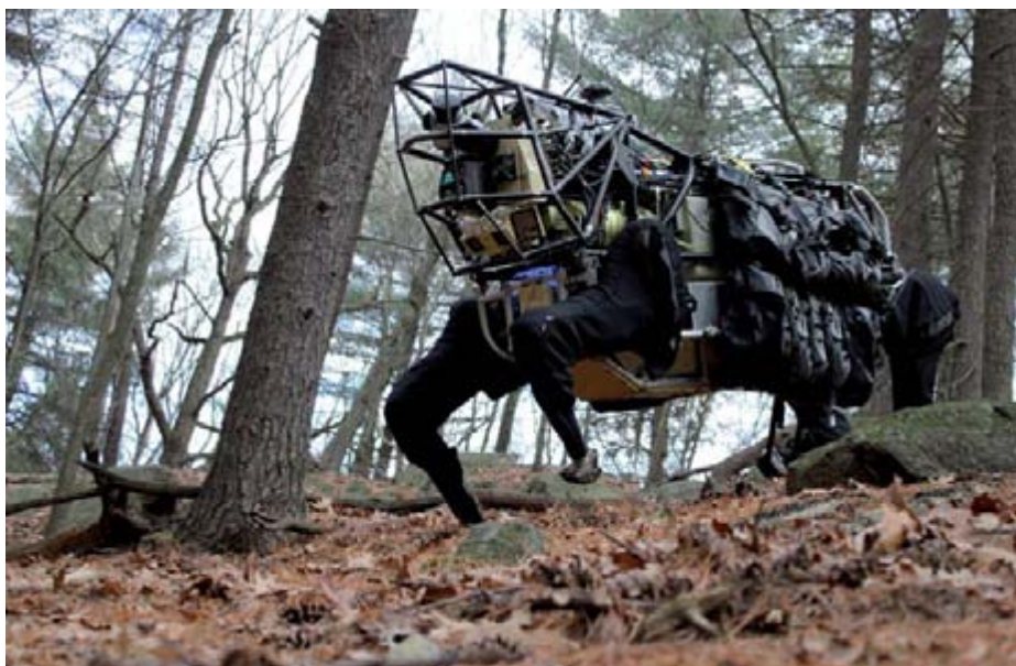
Big Dog corre por terrenos escarpados a 6,5 km/h.
