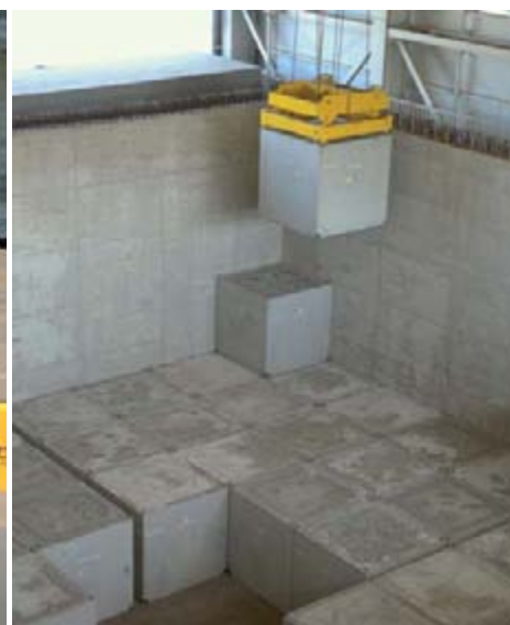
Vista aérea del almacén de residuos de baja y media actividad de El Cabril. Manejo automatizado de los bidones con los residuos y los contenedores donde se alojan.
