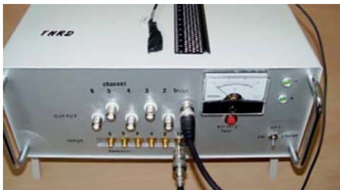
Figura 8. Nuevo detector de neutrones térmicos TNRD. El detector miniaturizado, se encuentra ubicado sobre su equipo electrónico asociado.
