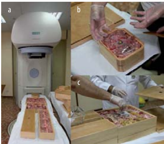
Figura 5. (a) Preparación del maniquí de tejido equivalente en la sala de tratamiento, (b) y (c) detalles de la composición y ubicación del detector en cabeza y abdomen.
