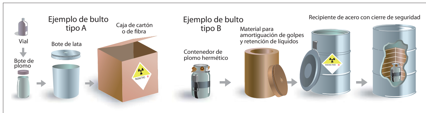
Características de los diferentes tipos de embalaje para la gestión de las fuentes radiactivas.
