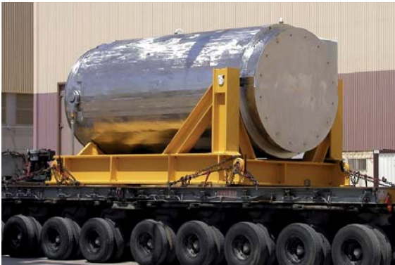
Figura 5. Traslado de un contenedor de doble propósito (DPT) de ENSA y vista del interior del ATI de Trillo.
