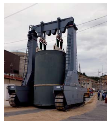
Figura 6. Componentes del sistema con cápsula multipropósito. Vistas de los ATI de José Cabrera en la parte superior y de Ascó en la parte inferior y del traslado del módulo cargado a esta última instalación.
