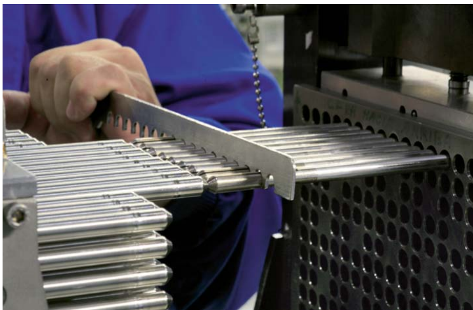
Medida del espacio entre las barras de combustible durante su proceso de fabricación.
