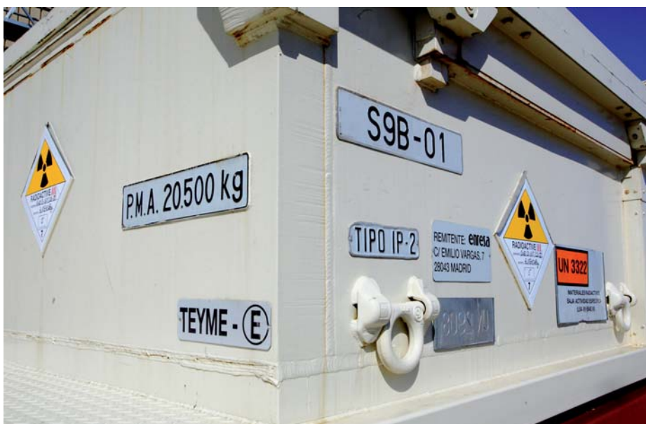
Señalización que debe identificar a un transporte de material nuclear o radiactivo.
