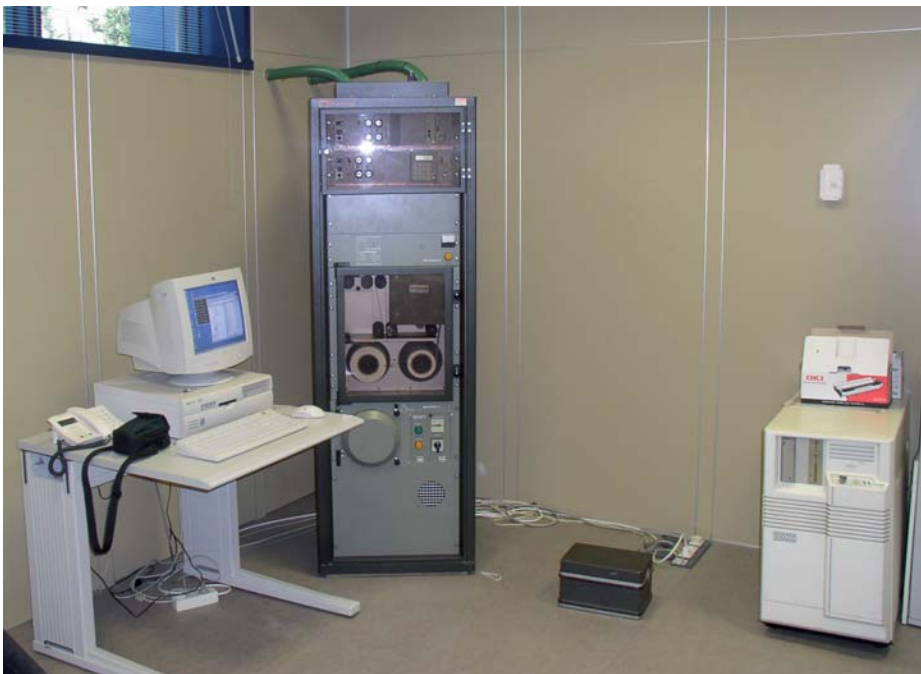
Estación radiológica automática (ERA) de una estación de la REA.
