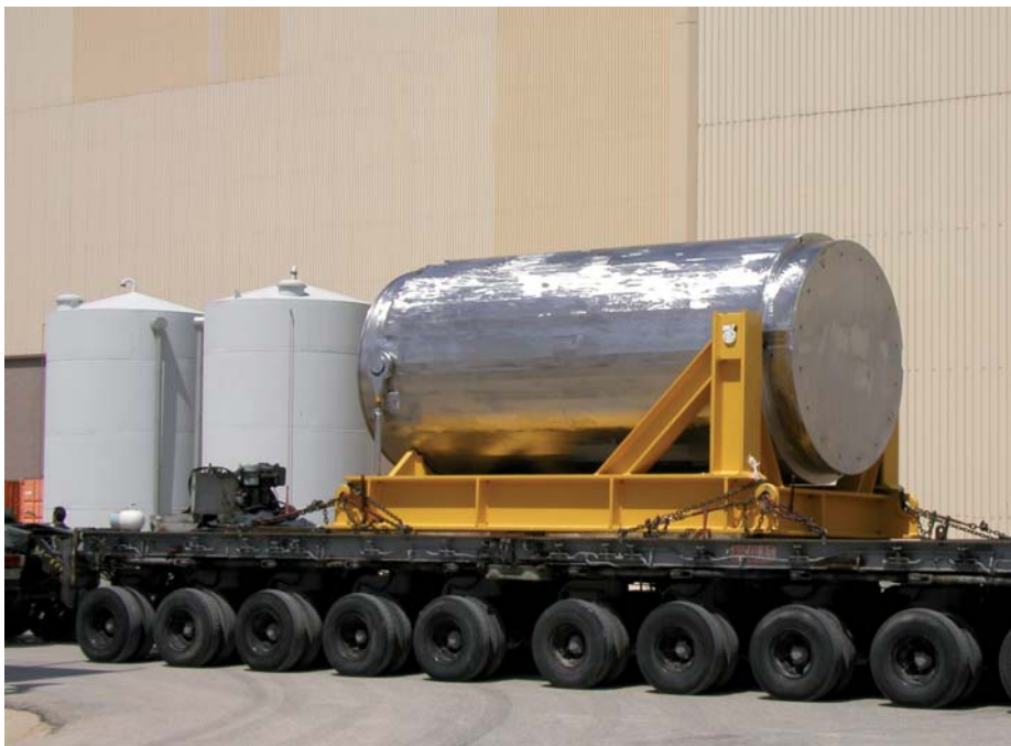
Transporte de un contenedor para almacenamiento de combustible en seco.
