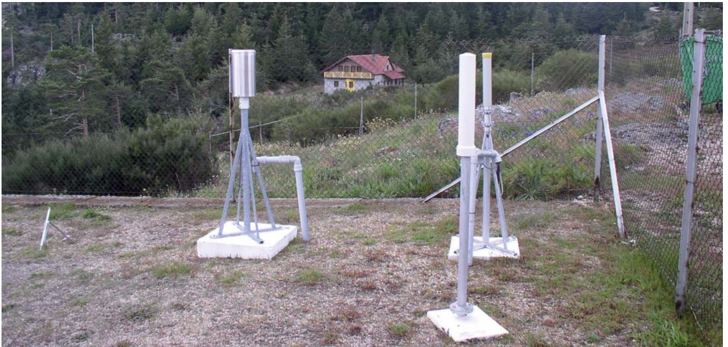
Sonda de tasa de dosis gamma e instrumentación de medida de parámetros meteorológicos de una estación de la REA.
