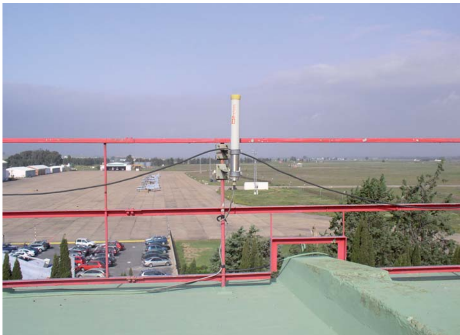
Sonda para la medida de tasa de dosis de una estación de la REA.
