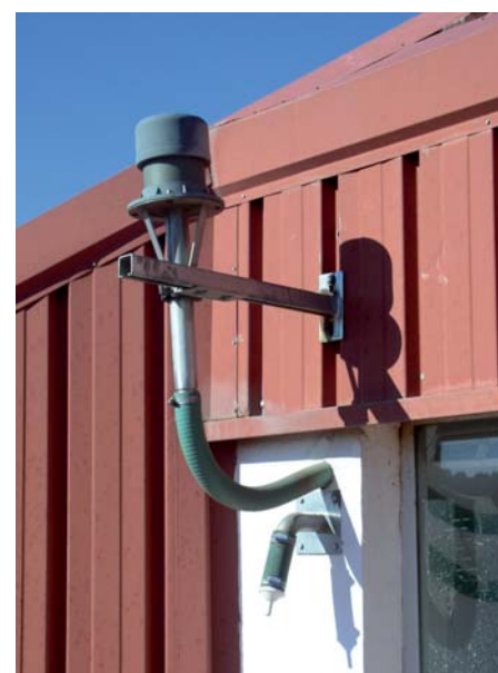
Toma de aire para la medida de concentración aerosoles ambientales (partículas alfa, beta y radiyodos) de una estación de la REA.
