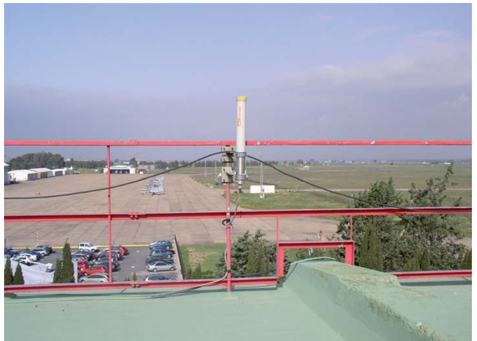
Sonda para la medida de tasa de dosis de una estación de la REA.
