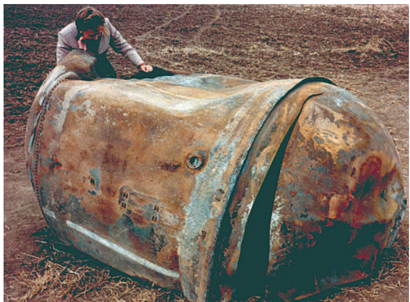
A la izquierda, carcasa de titanio del motor de un módulo Delta; con un peso de 70 kilos, aterrizó sobre Arabia Saudí a unos 240 km de Riad. A la derecha, un depósito de carburante de un cohete de lanzamiento Delta 2 que, con un peso de 250 kilos, aterrizó cerca de Georgetown.
