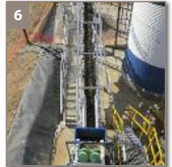
**4,5,6,7. LÍNEA LAVADO DE GRAVAS.** Las gravas se lavan en una rampa y se pasan por un escurridor vibrante. Desde este punto, se conducen mediante una cinta transportadora hasta el acopio de gravas desclasificables.
