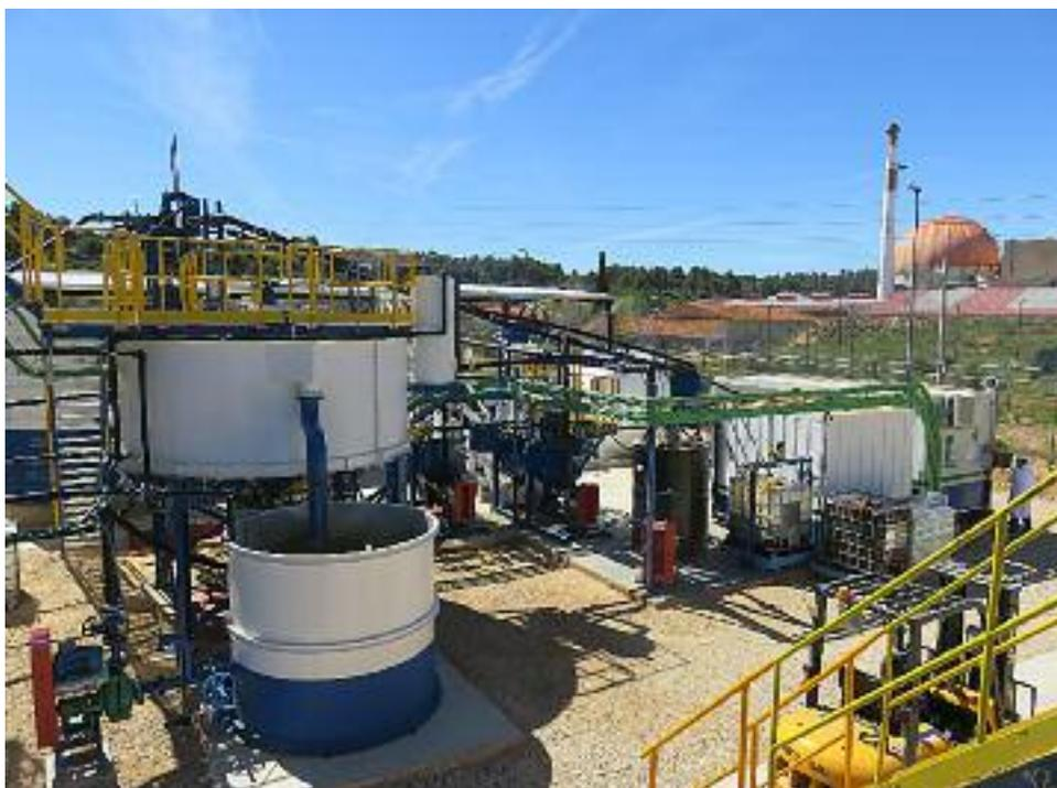
DESCONTAMINAR, SU OBJETIVO. La función de la planta de lavado de áridos es la de gestionar y tratar los suelos afectados por contaminación radiológica, utilizando técnicas de descontaminación
