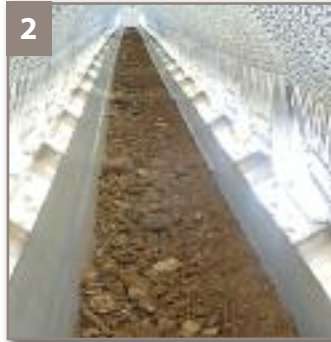
2, 3. LÍNEA DE CLASIFICACIÓN GRANULOMÉTRICA Y SEPARACIÓN DE GRAVAS. Desde la tolva se trasladan las tierras mediante la cinta de alimentación de banda transportadora, hasta el primer equipo de lavado: cilindro de lavado ("trome"). La mezcla de tierra lavada y agua de lavado se conduce por gravedad a una criba vibrante inclinada que permite clasificar granulométricamente.
