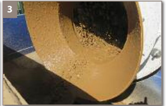
2, 3. LÍNEA DE CLASIFICACIÓN GRANULOMÉTRICA Y SEPARACIÓN DE GRAVAS. Desde la tolva se trasladan las tierras mediante la cinta de alimentación de banda transportadora, hasta el primer equipo de lavado: cilindro de lavado ("trome"). La mezcla de tierra lavada y agua de lavado se conduce por gravedad a una criba vibrante inclinada que permite clasificar granulométricamente.
