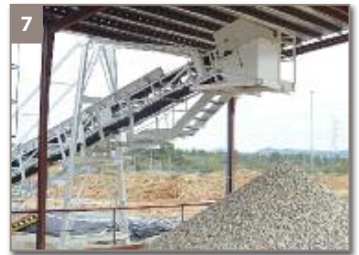
4,5,6,7. LÍNEA LAVADO DE GRAVAS. Las gravas se lavan en una rampa y se pasan por un escurridor vibrante. Desde este punto, se conducen mediante una cinta transportadora hasta el acopio de gravas desclasificables.
