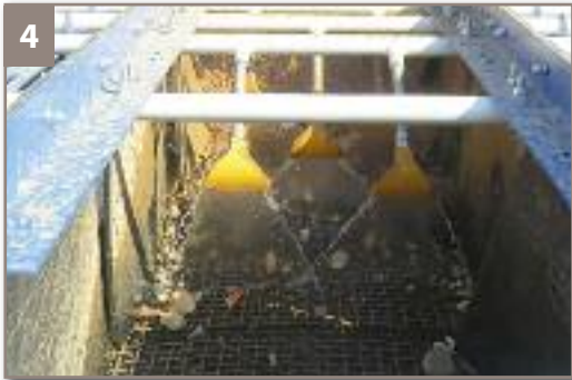
4,5,6,7. LÍNEA LAVADO DE GRAVAS. Las gravas se lavan en una rampa y se pasan por un escurridor vibrante. Desde este punto, se conducen mediante una cinta transportadora hasta el acopio de gravas desclasificables.
