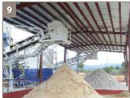
8-9. SEPARACIÓN DE FINOS Y LAVADO DE ARENAS. La separación entre arenas y finos tiene lugar a través de dos fases de hidrociclado, antes y después de proceso de lavado denominado atrición. Las arenas se descontaminan mediante un proceso de rozamiento desprendiéndose la contaminación adherida. Las arenas obtenidas, una vez escurridas, se conducen por medio de una cinta transportadora hasta el acopio de arenas desclasificables.
