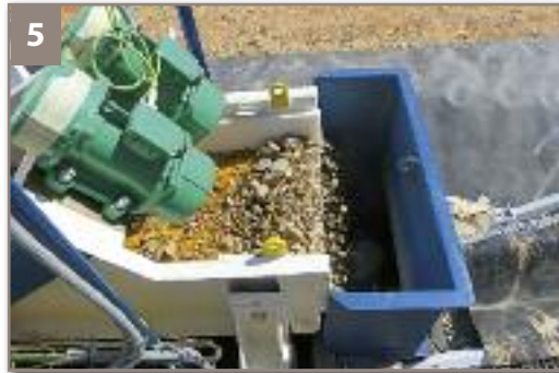
4,5,6,7. LÍNEA LAVADO DE GRAVAS. Las gravas se lavan en una rampa y se pasan por un escurridor vibrante. Desde este punto, se conducen mediante una cinta transportadora hasta el acopio de gravas desclasificables.
