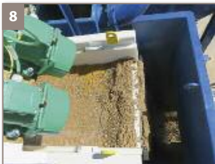
8-9. SEPARACIÓN DE FINOS Y LAVADO DE ARENAS. La separación entre arenas y finos tiene lugar a través de dos fases de hidrociclado, antes y después de proceso de lavado denominado atrición. Las arenas se descontaminan mediante un proceso de rozamiento desprendiéndose la contaminación adherida. Las arenas obtenidas, una vez escurridas, se conducen por medio de una cinta transportadora hasta el acopio de arenas desclasificables.
