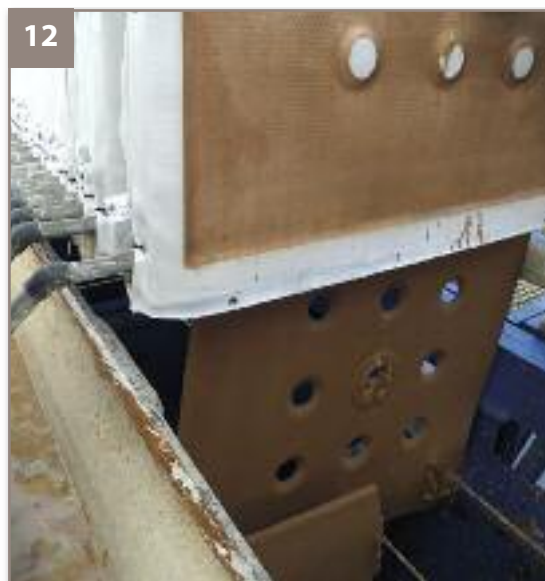
11-12. LA ETAPA DE FILTRACIÓN SE REALIZA MEDIANTE UN FILTRO-PRESA. En el cual se consigue concentrar todo el material fino compactado en condiciones adecuadas ("tortas").
